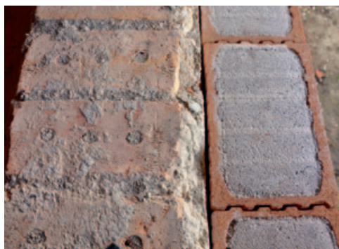
Ziegel mit Füllung aus Perlit
